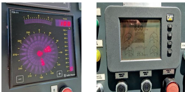
3.3 pav. Kairėje – azimuto sraigto „Rolls Royce Aquamaster US 205“ parametrų daviklis („Rolls-Royce Aquamaster TDI-11“), dešinėje – vilkiko variklio „Caterpillar 3516 B-HD DITA“ parametrų valdiklis
